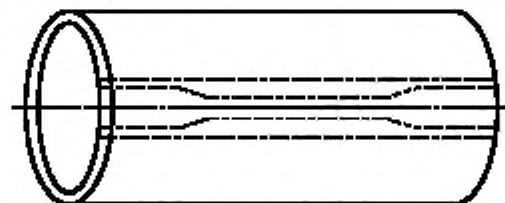
с — Образец в виде полосы для испытания на растяжение
